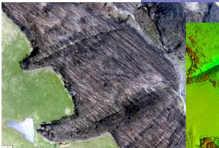
Fig. 12. Exemplu de filtrare a unei păduri de foioase fotografiată primăvara devreme. a-b vedere din lateral a modelului de teren, cu vegetație (a), fără vegetație (b); (c) – imagine aeriană a fortului, vedere verticală; (d) – model cu pădure și case, vedere verticală; (e) – model fără vegetație, vedere verticală). Exemplu – fortul Albota, lângă Pitești
