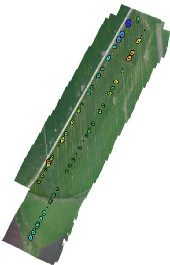
Fig. 10. Reprezentarea erorilor în punctele de achiziție a imaginilor (dimensiunea elipselor reflectă diferențele pe x,y) și culoarea - cele pe Z, în cazul unei referențieri spațiale automate folosind GPS-ul dronei
